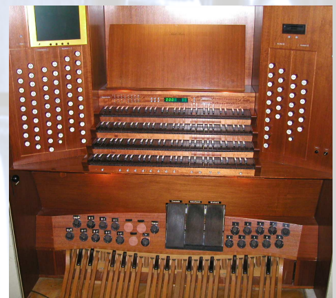
Koppeln: III-II, III-I, II-I, IV-P, III-P, II-P, I-P Orgel Plenum, Zungen ab, Crescendo, Setzer
